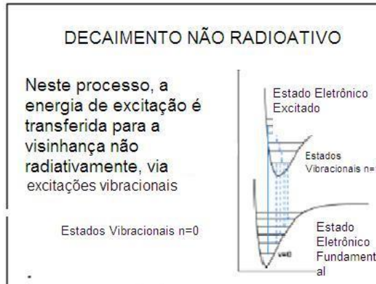
Figura 4.5 – Decaimento não-radioativo: após absorver um fóton, uma molécula vai para um estado eletrônico excitado. Muito provavelmente para um dos estados vibracionais da molécula. Outros processos ocorrem (decaimentos radioativos), trazendo a molécula de volta para o estado eletrônico fundamental [29].
